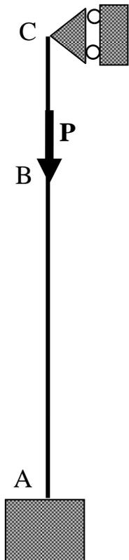
On veut étudier la stabilité de la structure ci-contre, constituée d'une poutre AC de longueur  $L$ , de section d'inertie  $I$ , de matériau ayant un module d'Young  $E$ . Cette poutre est en liaison encastrement au point A. Elle a un appui glissant au point C.
