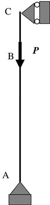
On veut étudier la stabilité de la structure ci-contre, constituée d'une poutre AC de longueur  $L$ , de section d'inertie  $I$ , de matériau ayant un module d'Young  $E$ . Cette poutre est en liaison rotule au point A et en appui glissant en C. Elle supporte une charge axiale  $P$  au point B défini par la distance  $AB = b$ .
