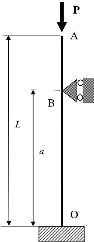
On veut étudier la stabilité de la structure ci-contre, constituée d'une poutre de longueur  $L$ , de section d'inertie  $I$ , de matériau ayant un module d'Young  $E$ . La section en O est encastree sur un massif indéformable, le point B (situé à la distance  $a$  du point O) est en appui simple.
