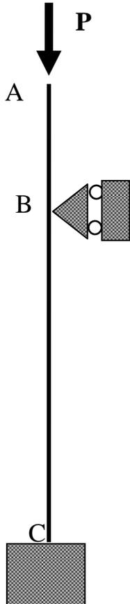
On veut étudier la stabilité de la structure ci-contre, constituée d'une poutre AC de longueur  $L$ , de section d'inertie  $I$ , de matériau ayant un module d'Young  $E$ . Cette poutre est en liaison encastrement au point C. Elle a un appui glissant au point B défini par la distance  $AB = a$ .
